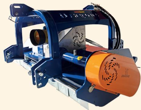
Das **Modell VPO** mit niedrigem Keilriementrieb ist in den Arbeitsbreiten von 175 - 240 cm verfügbar. Der Mulchkasten ist komplett aus einem 6 + 5 mm starkem Qualitätsstahl - Doppelblech gefertigt und zerkleinert problemlos Äste von bis zu **15 cm** Durchmesser.
